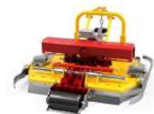
La gamme LMG est conçue pour offrir un broyage intensif combiné à une gestion douce de l'inter-rang, même dans les conditions les plus exigeantes. Polyvalente et robuste, elle permet de traiter efficacement de grandes surfaces en un seul passage.
