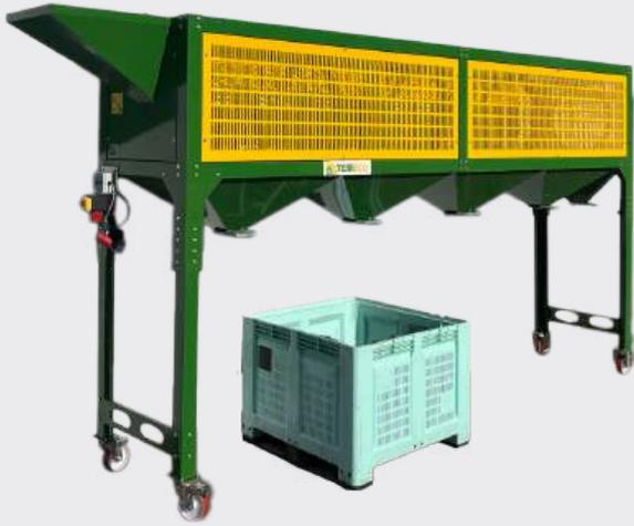
La calibreuse TCC est un outil essentiel pour le tri efficace et rapide des fruits à coques tels que les noix, les châtaignes et les noisettes. Robuste, fiable et facile à utiliser, elle assure une séparation précise selon les diamètres, optimisant ainsi la qualité de vos lots et leur valorisation commerciale.
