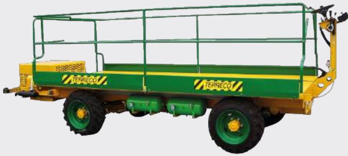
La plateforme de cueillette TERRECO est conçue pour les professionnels de l'arboriculture recherchant performance, fiabilité et confort. Elle se distingue par son moteur positionné à l'arrière, permettant une hauteur de châssis plus basse que la moyenne, idéale pour intervenir dans des plantations basses ou étroites.
