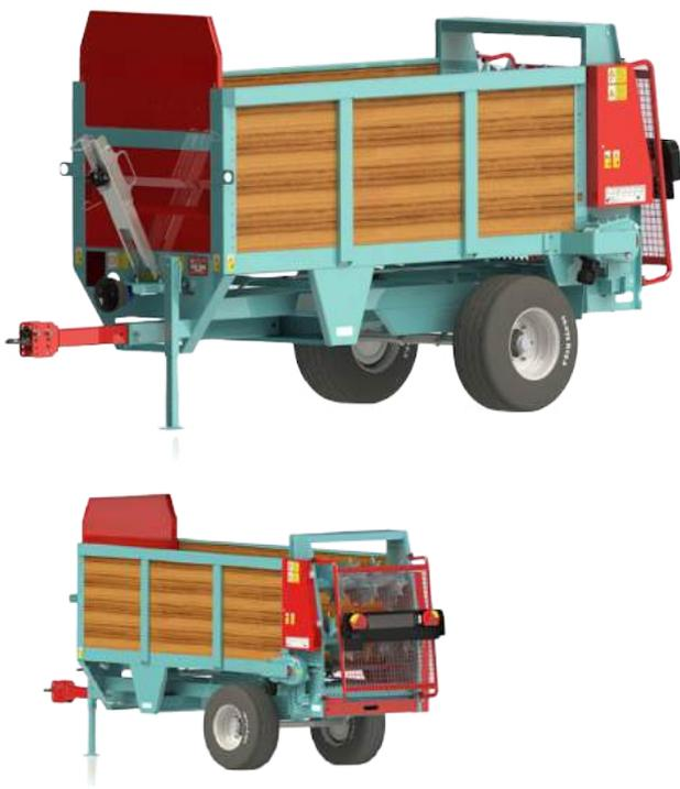
Les épandeurs T.A.F.O. RS, TRE et TTA sont conçus pour un épandage arrière performant, précis et fiable, de matières organiques solides. Disponibles en plusieurs volumes, ces épandeurs répondent aux besoins des exploitations agricoles de toutes tailles, en assurant une répartition homogène du fumier sur le terrain.
