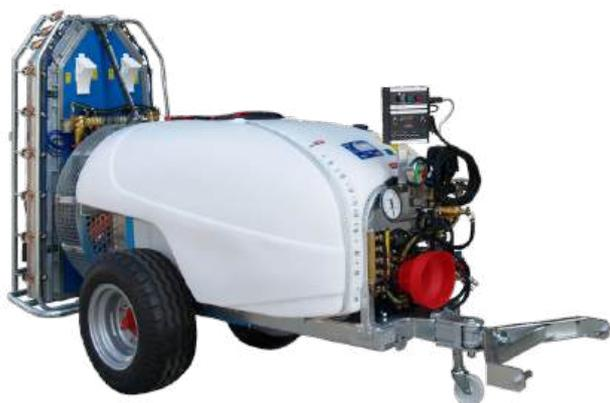
Conçu pour le traitement intensif des vergers, cet atomiseur se distingue par sa compacité et son système à double turbine tournant en sens inverse, garantissant une diffusion homogène et puissante du produit. Grâce à un rectificateur d'air spécifique, il génère un flux tourbillonnant optimisant la couverture foliaire.
