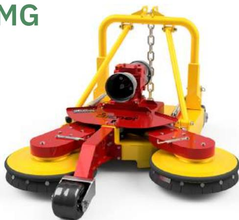
Conçu spécialement pour l'entretien des cultures sur tablettes (table-top), le broyeur KMG se distingue par sa maniabilité exceptionnelle et sa grande efficacité, même avec de petits tracteurs.
