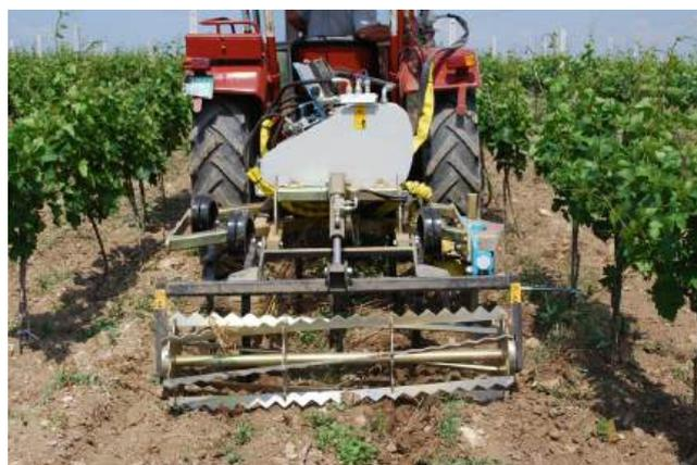
Le Cultivateur terreco est un cultivateur robuste à dents fixes, conçu pour le travail en profondeur, le décompactage léger et la préparation du sol avant semis. Doté d'une structure soudée renforcée, il est équipé d'ancres réglables et mobiles, permettant d'adapter l'outil aux différentes conditions de sol.
